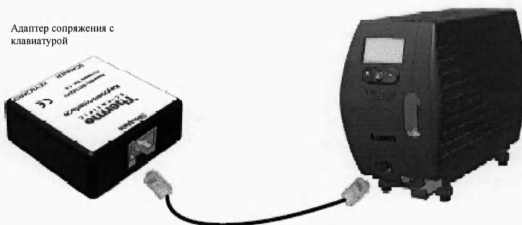
Рисунок 18 – Подключение адаптера сопряжения к клавиатуре
