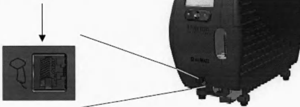
Рисунок 1 – Подключение сканера штрих-кодов
