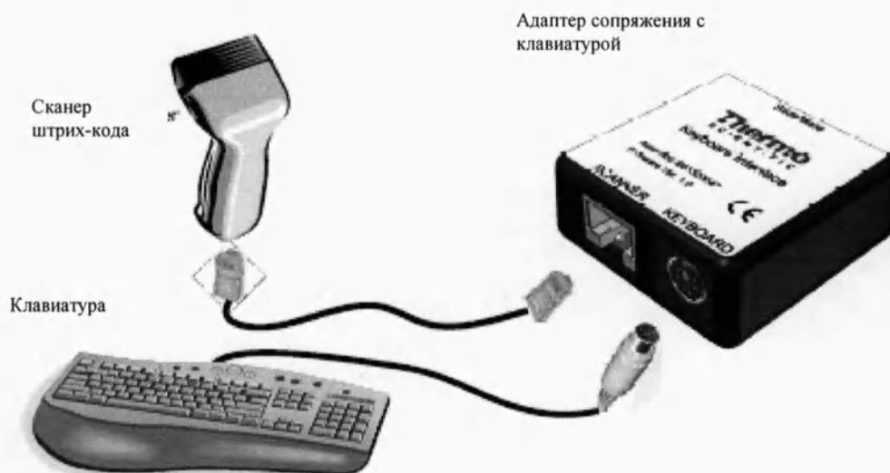
Рисунок 19 – Подсоединение клавиатуры и сканера штрих-кода
