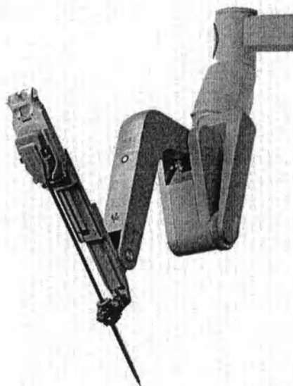
Рис. 2.12 Пример манипулятора с прикрепленным инструментом
