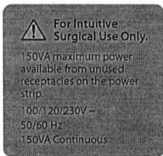
Рис. 1.3 Этикетка с предупреждением на встроенном разветвителе питания видеостойки
