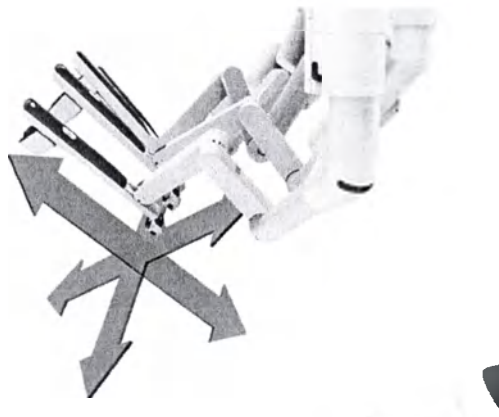
Рисунок 9.20 Движения зажима порта
