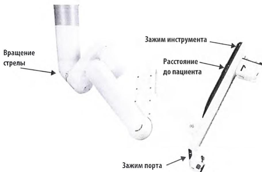
Рисунок 2.5 Кнопки на манипуляторах стойки пациента для активации перемещений
