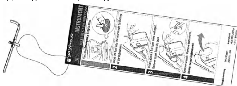
Рисунок 9.34 Комплект для высвобождения инструмента
