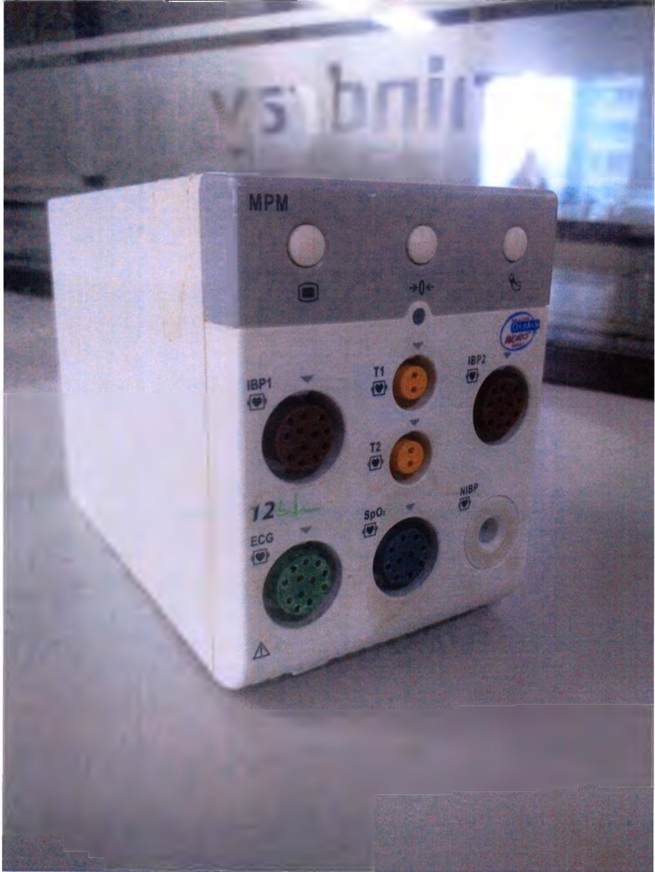
Мультипараметрический модуль: НИАД, температура, Nellcor SpO2, 3/5 отведений ЭКГ, ИАД
