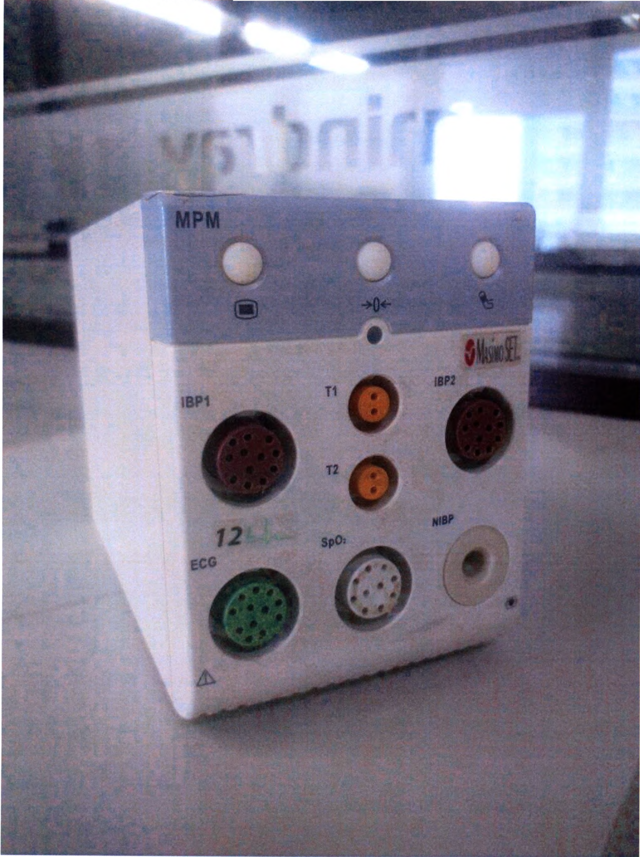
Мультипараметрический модуль: НИАД, температура, Masimo SpO2, 12 отведений ЭКГ, ИАД
