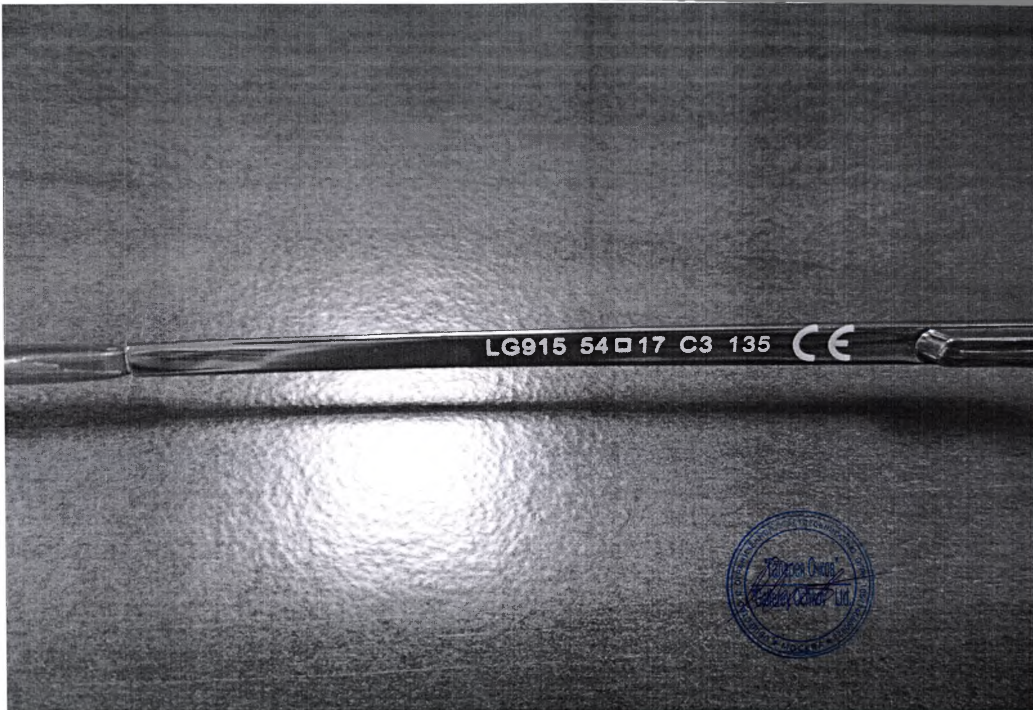
Оправа корригирующих очков металлическая. Маркировка заушника. ЭЛЕКТРОННАЯ КОПИЯ ОФОРМЛЕНА ЦЕНТРОМ ИСПЫТАНИЙ И РЕГИСТРАЦИИ МЕДИЦИНСКИХ ИЗДЕЛИЙ
