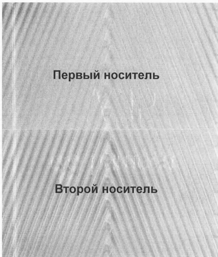
Рис. 6. Схема соединения двух V-образных носителей. Рифленый узор продолжается от одного носителя к другому.
