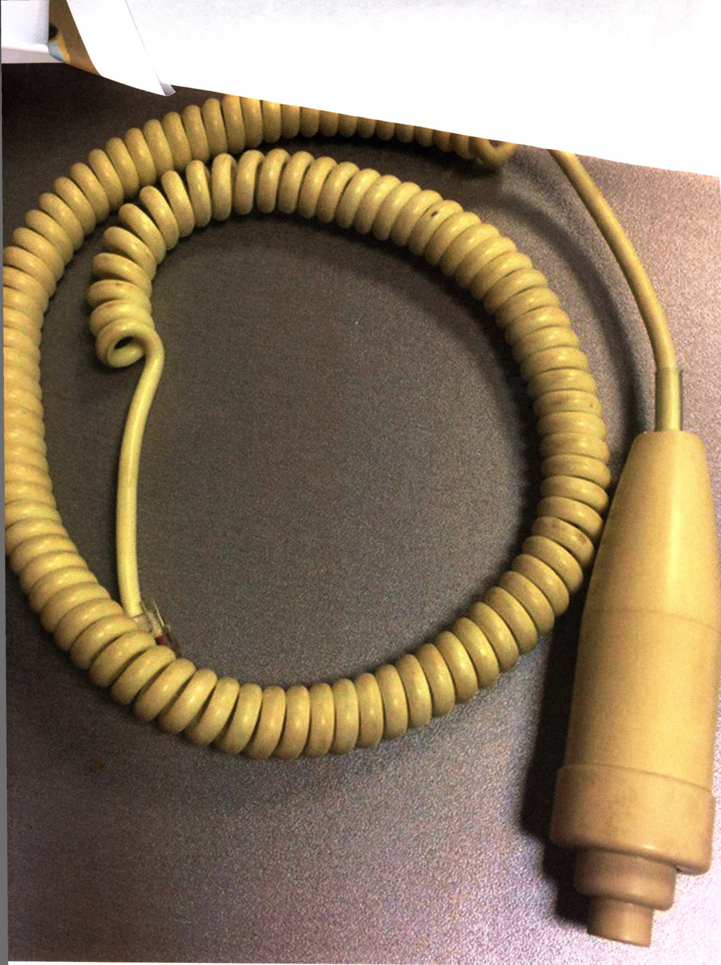
Кабель с кнопкой включения высокого рентгеновского излучения
