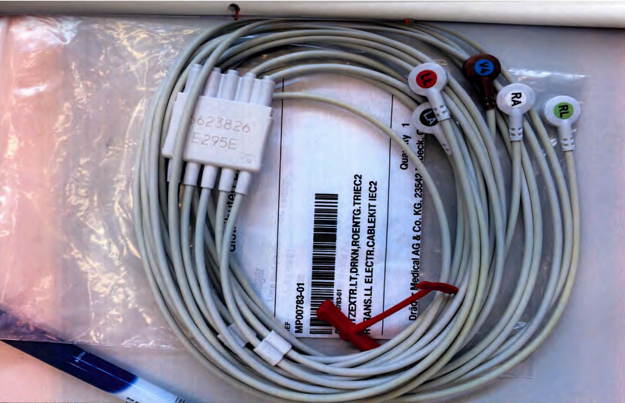
Рисунок 10.3. Комплект ЭКГ-переходников:- разъемы для ЭКГ отведений для туловища и грудной клетки (не более 2 шт.), - кабели ЭКГ отведений для конечностей (не более 5 шт.), - кабели ЭКГ отведений для грудной клетки (не более 6 шт.)
