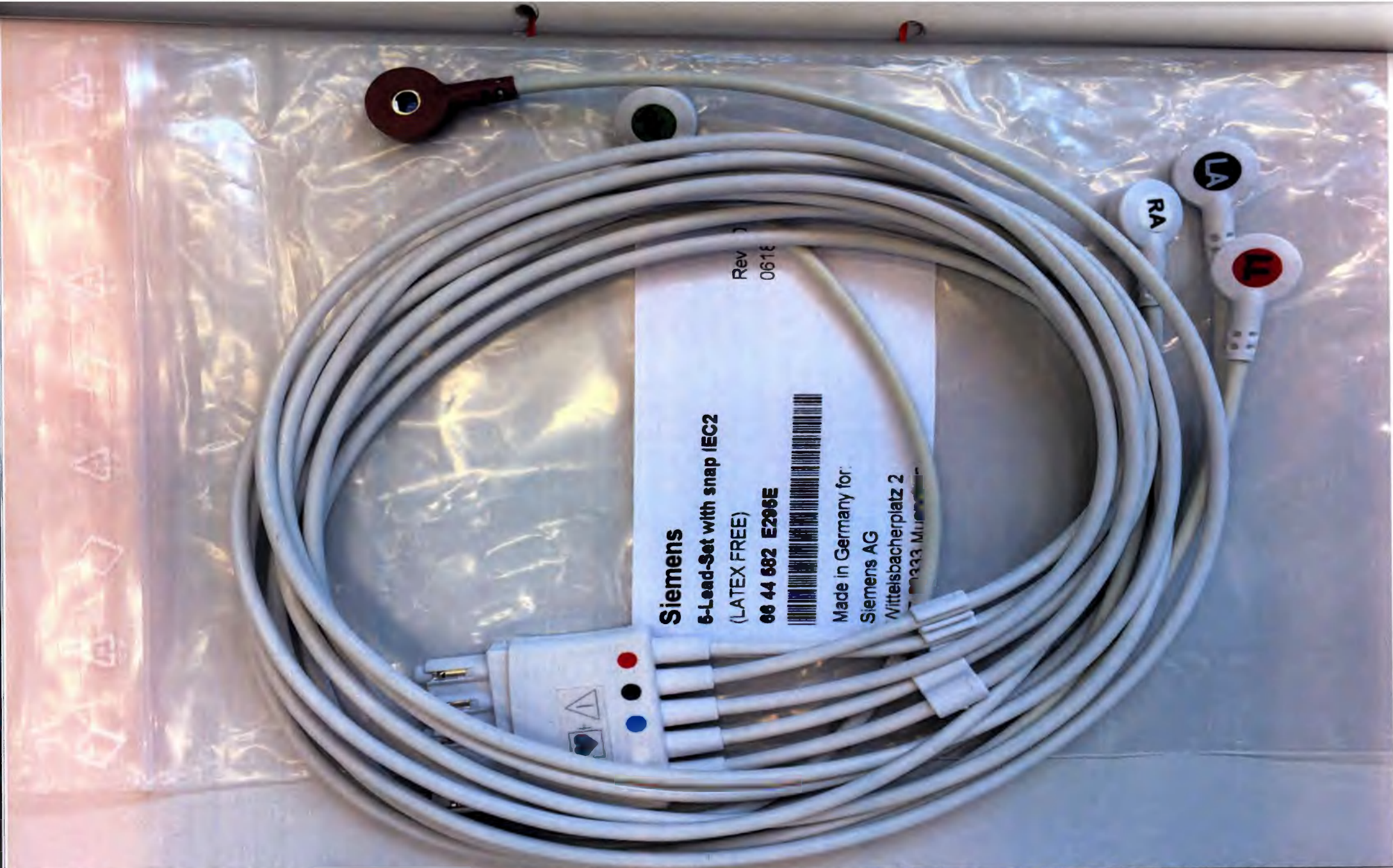
Рисунок 9.4. Комплект ЭКГ-переходников:- разъемы для ЭКГ отведений для туловища и грудной клетки (не более 2 шт.), - кабели ЭКГ отведений для конечностей (не более 5 шт.), - кабели ЭКГ отведений для грудной клетки (не более 6 шт.)
