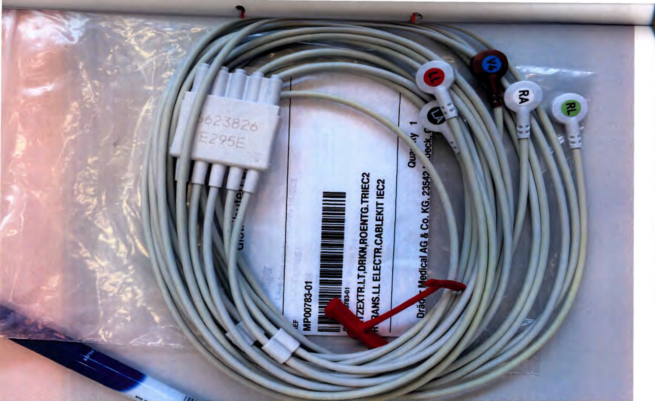
Рисунок 9.3. Комплект ЭКГ-переходников:- разъемы для ЭКГ отведений для туловища и грудной клетки (не более 2 шт.), - кабели ЭКГ отведений для конечностей (не более 5 шт.), - кабели ЭКГ отведений для грудной клетки (не более 6 шт.)
