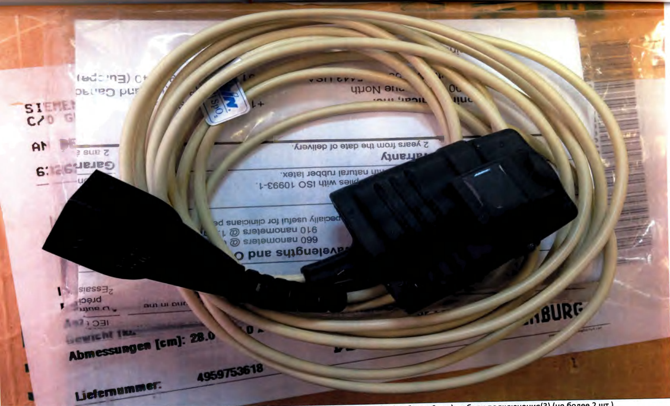
Рисунок 6.1. Комплект подключения датчиков SpO2: датчики SpO2 взрослый(1) и/или детский(2) (не более 2 шт.), кабели подключения(3) (не более 2 шт.)
