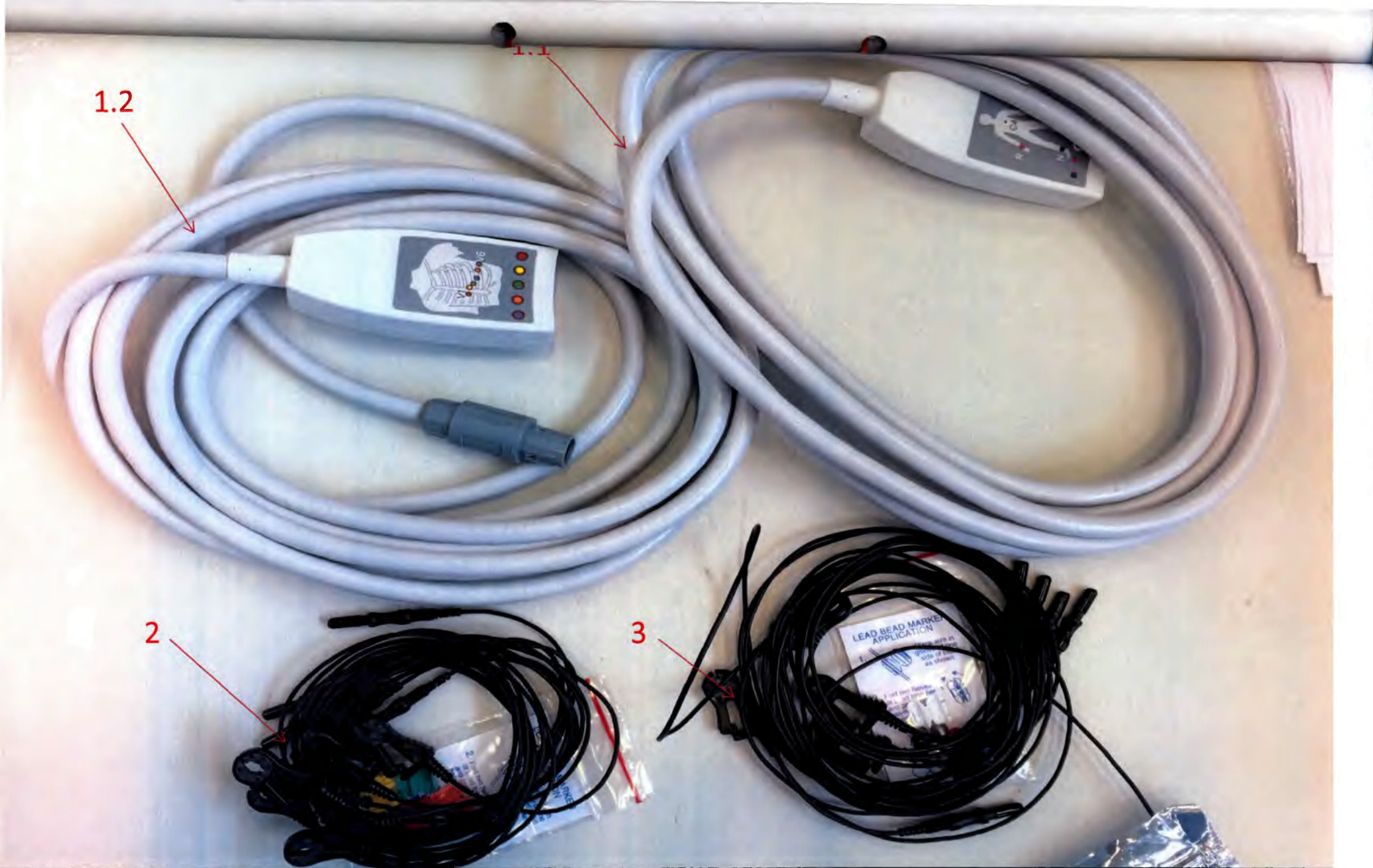
Рисунок 8.1. Комплект рентгенопрозрачных ЭКГ-отведений: - разъемы для ЭКГ отведений для туловища(1.1) и грудной клетки (1.2), - рентгенопрозрачные кабели ЭКГ-отведений для конечностей (2), - рентгенопрозрачные кабели ЭКГ-отведений для грудной клетки (3), - рентгенопрозрачные ЭКГ-электроды (не более 100 шт.)
