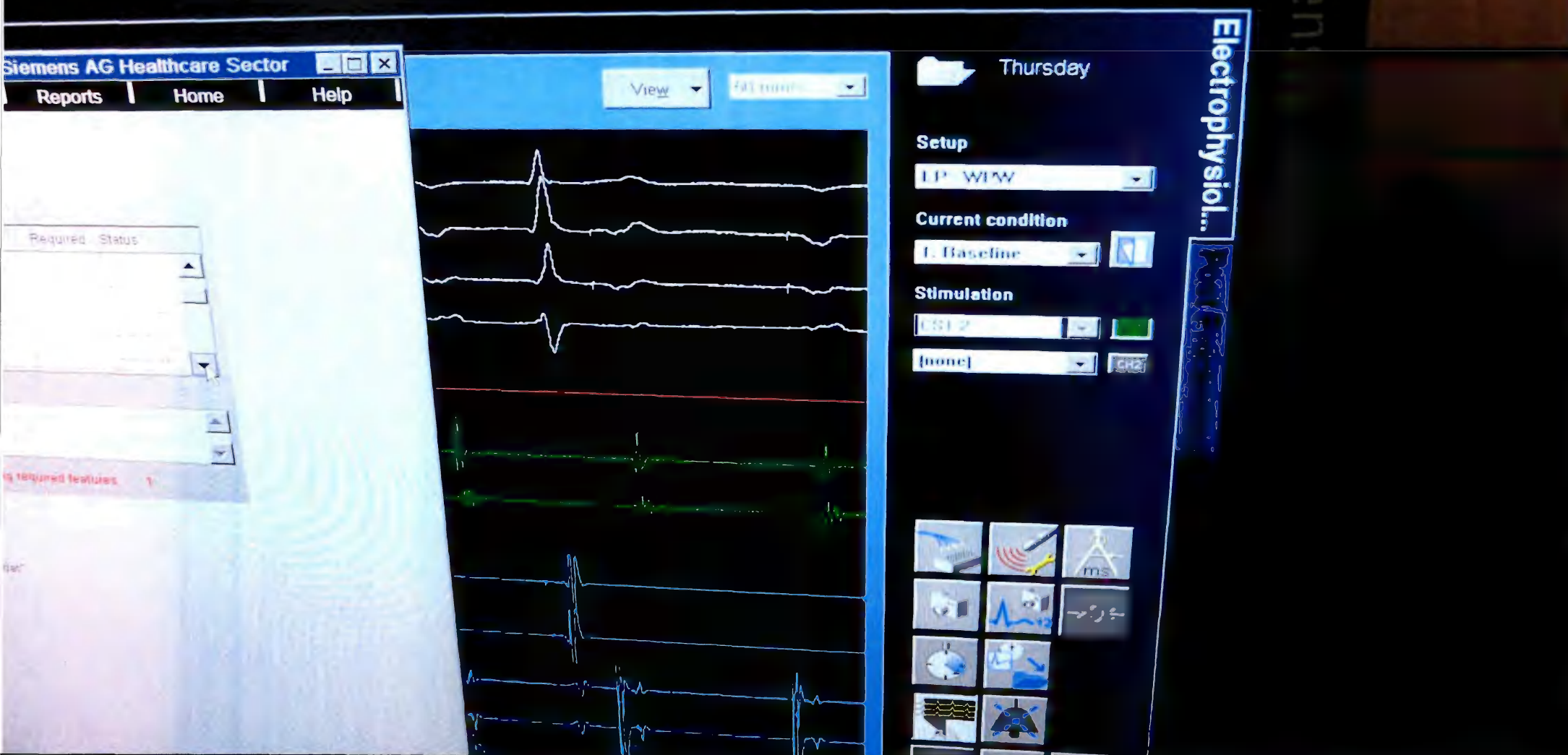
Рисунок 1.2. Модуль программно-аппаратный для Электрофизиологии в составе: - блок подключения катетеров Sensis (IECG), - приложение Электрофизиология (Electrophysiology)
