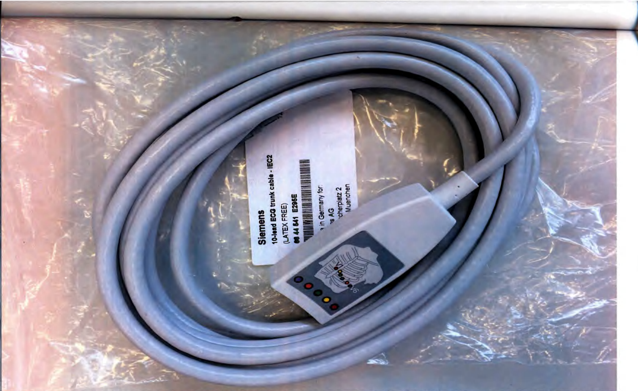
Рисунок 10.2. Комплект ЭКГ-переходников:- разъемы для ЭКГ отведений для туловища и грудной клетки (не более 2 шт.), - кабели ЭКГ отведений для конечностей (не более 5 шт.), - кабели ЭКГ отведений для грудной клетки (не более 6 шт.)
