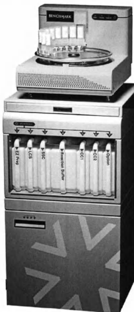
Рисунок 18. Модули окрашивания, автоматического пополнения жидкостей и обработки отходов.
