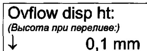
Рис.61. Регулировка высоты расположения промывающей головки при переливе в режиме "teach in".
