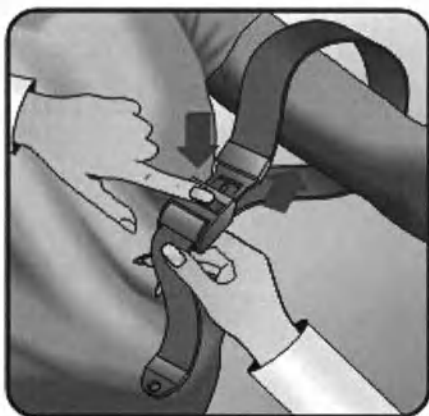
Рис. 4 Для освобождения ленты после проведения манипуляций нажать
