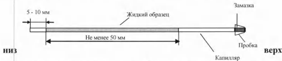
Рис. 16. Позиция исследуемого жидкого образца в стеклянном капилляре.
