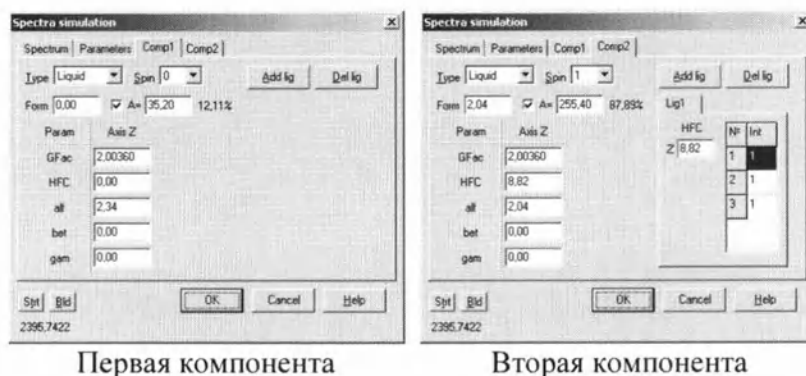
Рис. 11. Параметры компонент модели ЭПР-спектра образца, содержащего радикалы 1,1-дифенил-2-пикрилгидразина (ДФПГ) в спиртово-водном растворе.
