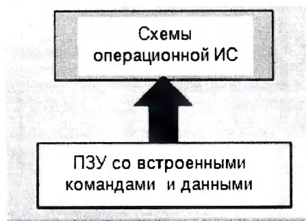
Рисунок 9.2.2 – Структурная схема программного обеспечения, встроенного в ЦСП
