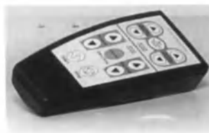
Рис. 12. Пульт управления для консолей артроскопических помп
