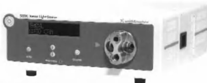
Рис. 8. Консоль источника света ксенонового
