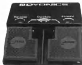
Рис. 11. Педаль управления для консолей артроскопических помп
