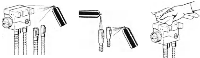
Рис. 13. Очистка держателя наконечников, шлангов и терминалов
