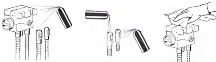
Рис. 13. Очистка держателя наконечников, шлангов и терминалов
