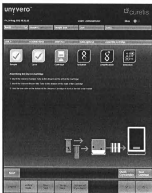
Рисунок 23 Требования к сборке картриджа
