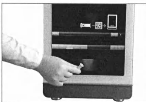
Рисунок 17 Сканирование пробирок с образцами
