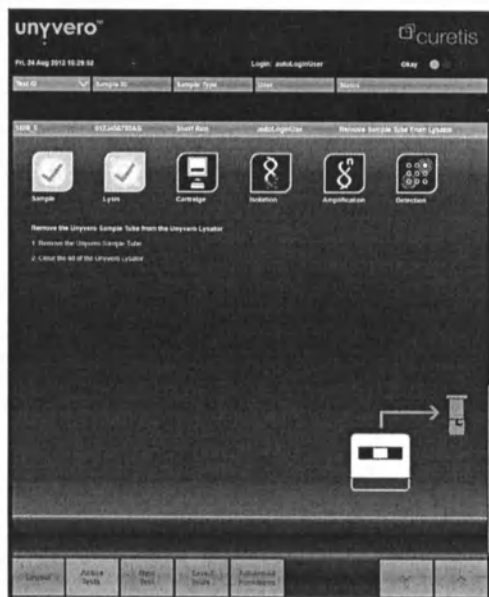
Рисунок 21 Требования к извлечению Пробирок для образцов Unyvero™ в Модуль для лизирования Unyvero™ Lysator
