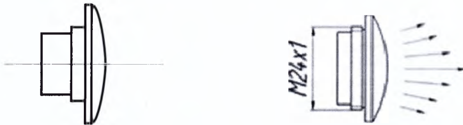
Рис. 1 Внешний вид и диаграмма излучения насадки.
