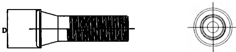
Рис. 23. Цилиндр пластиковый Допустимое отклонение: менее 6 мм \pm 0.05 мм, выше 6 мм \pm 0.1 мм Наружная резьба: шаг = 0.3 \pm 0.05 мм, высота профиля = 0.15 \pm 0.05 мм Длина цилиндра = 12 \pm 0.01 мм
