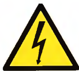
Опасность поражения электрическим током
