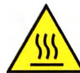
Осторожно! Горячая поверхность
