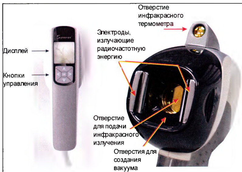
рис. 2: Малый аппликатор «VContour» [слева: пульт управления / справа: детали аппликатора]
