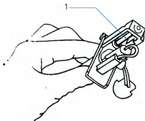
Рисунок 34. Смазка механизма стержня зонда
