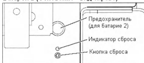
Батарея 2 (Основание - вид справа)
