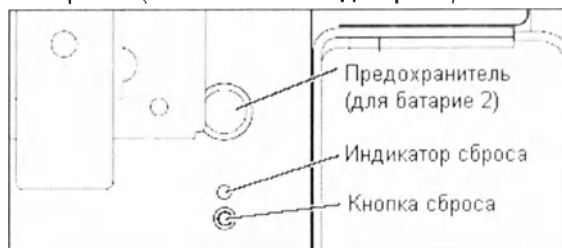
Батарея 2 (Основание - вид справа)
