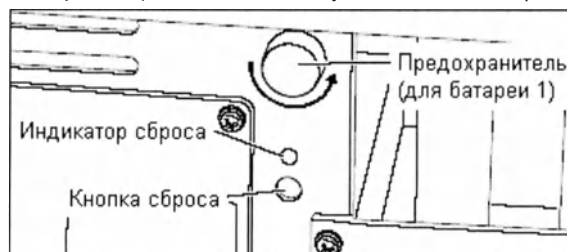
Батарея 1 (Основной модуль - вид сзади)
