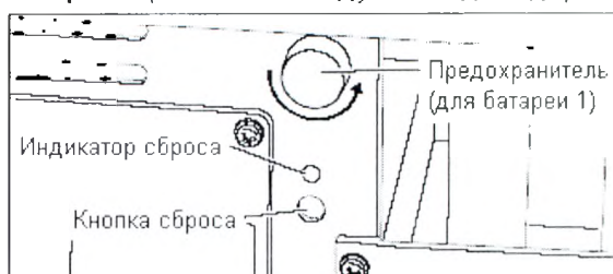
Батарея 1 (Основной модуль - вид сзади)
