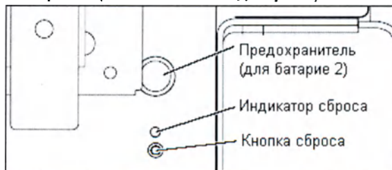
Батарея 2 (Основание - вид справа)
