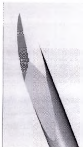
Рисунок 4. Типичная форма ланцета с острым концом, тремя поверхностями и двумя режущими углами.
