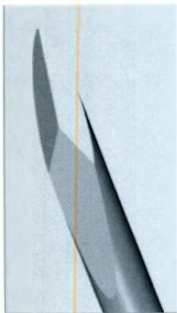
Рисунок 4. Типичная форма ланцета с острым концом, тремя поверхностями и двумя режущими углами.
