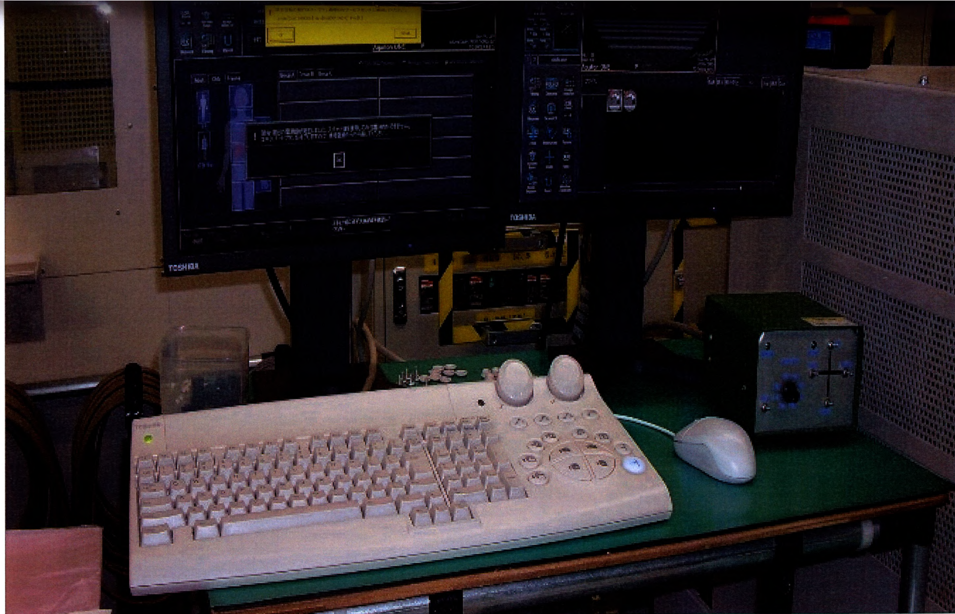
12а. Консоль обработки изображений: - монитор для обработки изображений; - клавиатура для обработки изображений; - компьютерная мышь.
