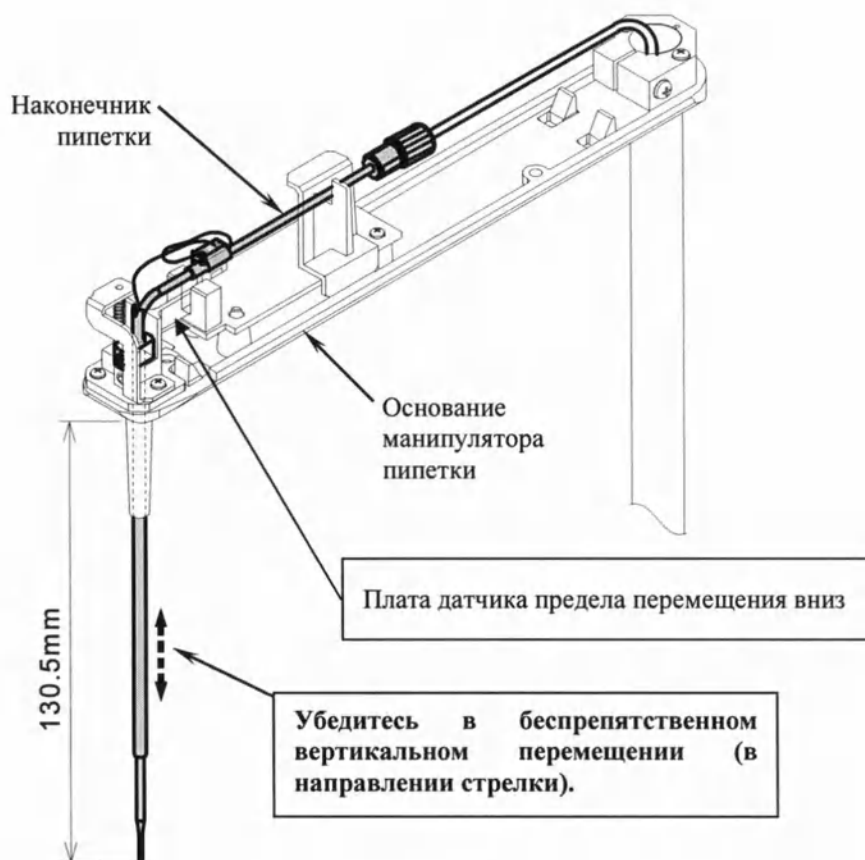
Проверка установки наконечника пипетки
