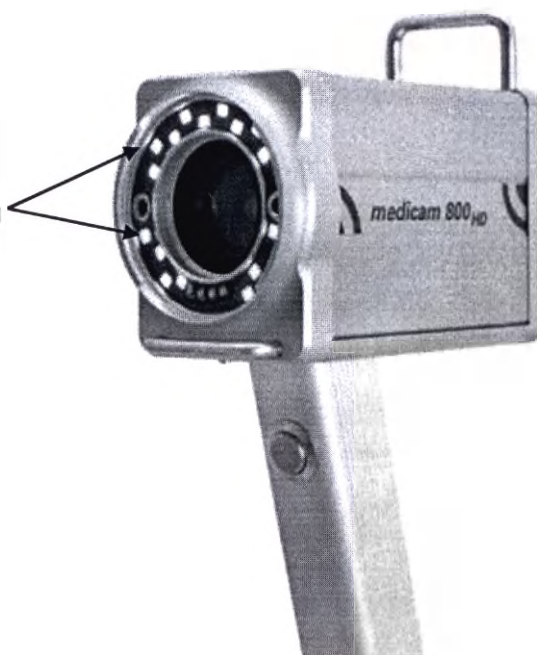
Фото 4. Видеокамера "Медикэм 800 Эйч-Ди" со встроенной интенсивной подсветкой.
