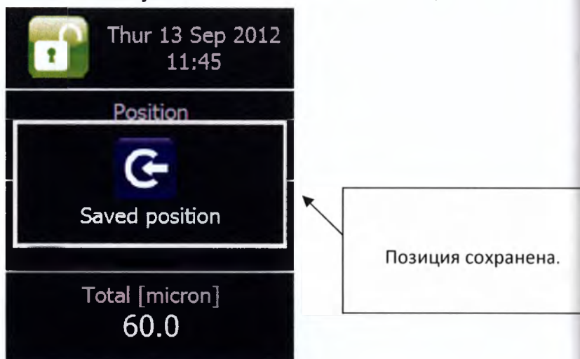
Рис.17. Информация на экране о запоминании позиции держателя образца.
