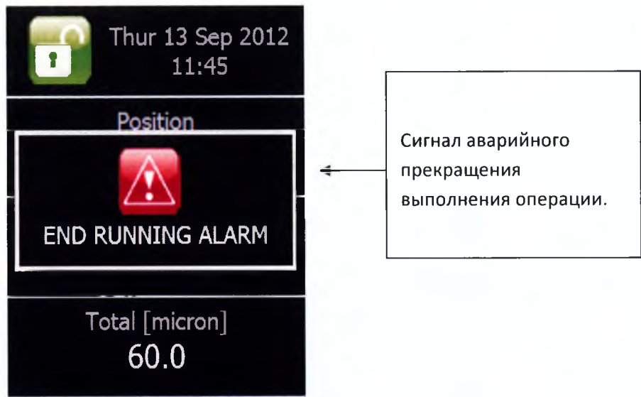
Рис.20. Информация об аварийной остановке в работе.
