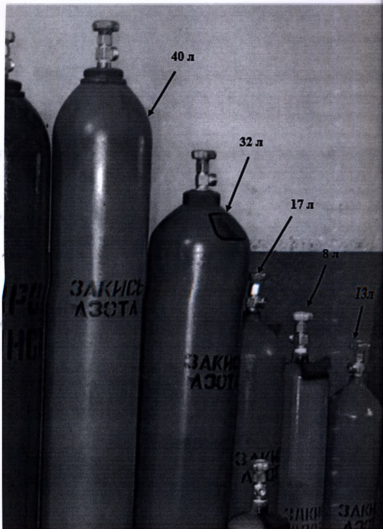
Фотография 2. Баллоны для закиси азота 8, 13, 17, 32, 40 литров, ТУ 9467-001-54553586-2015. Общий вид.
