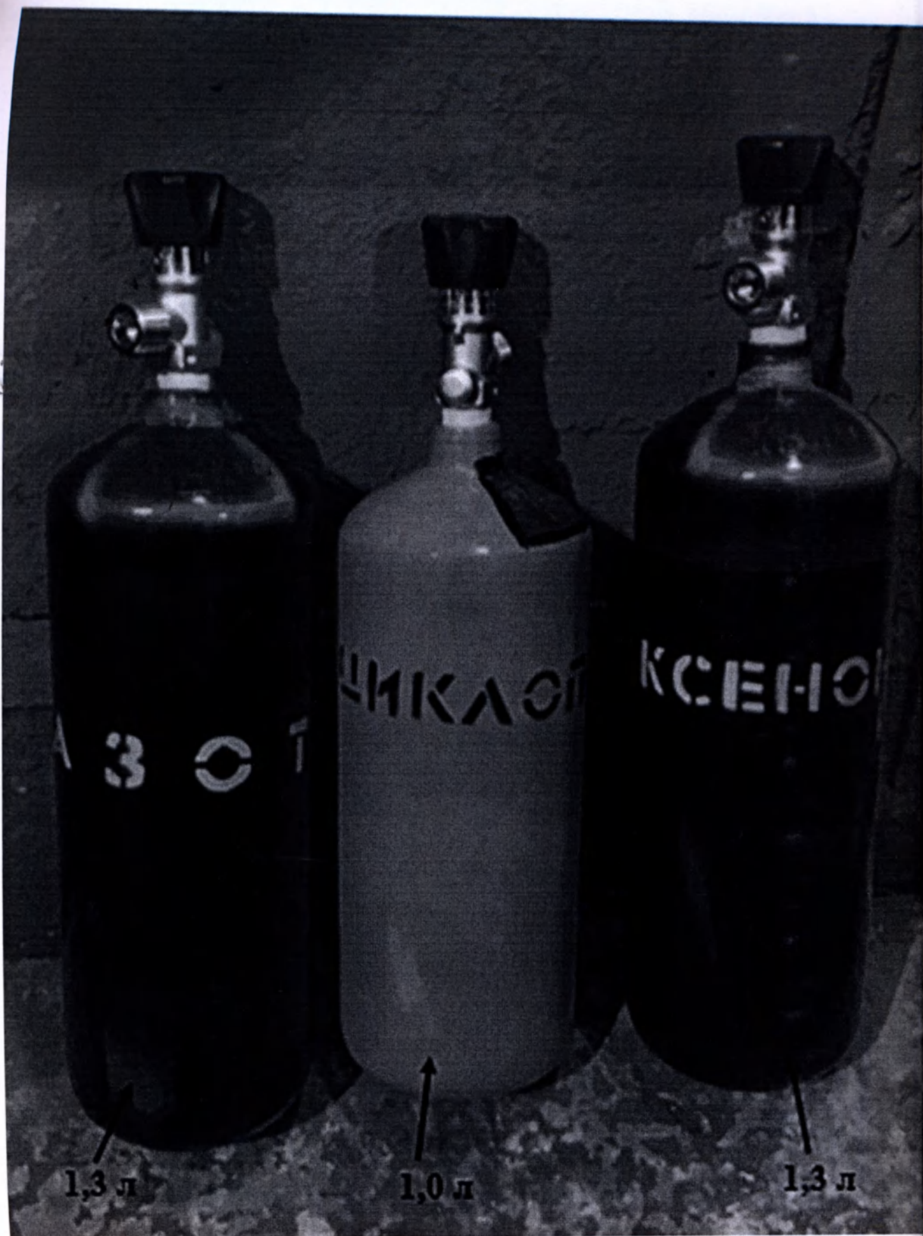
Фотография 6. Баллон для азота, 1,3 литра; баллон для циклопропана, 1,0 литра; баллон для ксенона, 1,3 литра, ТУ 9467-001-54553586-2015. Общий вид.
