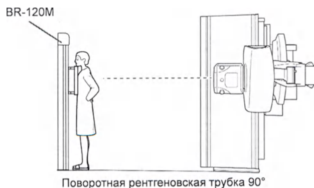
Рис. 1.4. Рентгенография с использованием стойки Букки (BR-120M)
