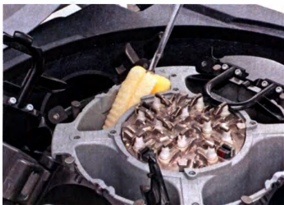
Рис. 5-8: Очистка держателя мешков для компонентов крови
