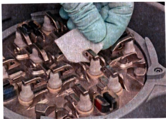
Рис. 5-10: Очистка запаивающего клапана с применением марлевого тампона, смоченного в растворе изопропилового спирта
