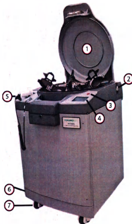
Рисунок 1: Изделие Reveos с 1) крышкой изделия; 2) силовым выключателем; 3) кнопкой останова; 4) дисплеем с сенсорным экраном; 5) сканером штрих-кода; 6) ящиком для доступа; и 7) колесиками.
