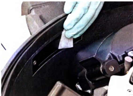
Рис. 5-12: Очистка датчика утечки жидкости
