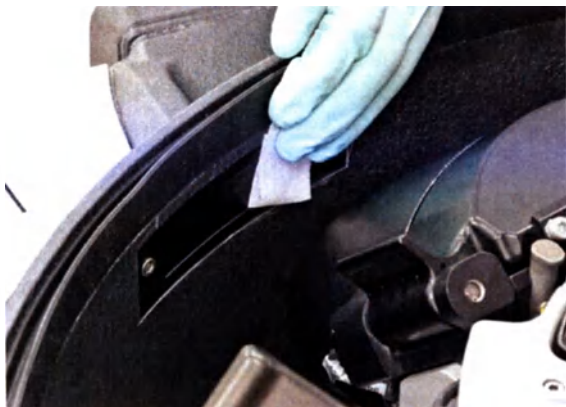
Рис. 5-2: Очистка датчика утечки жидкости
