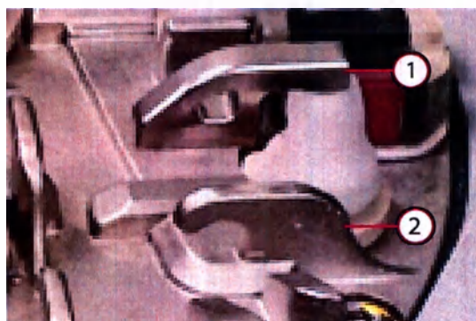
Рисунок 5: Подробное изображение перекрывающего клапана и направляющей для трубки с 1) перекрывающим клапаном и 2) направляющей для трубки
