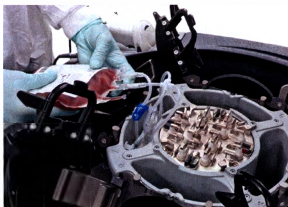
Рис. 3-14: Мешки, размещенные в держателе мешков для компонентов крови
