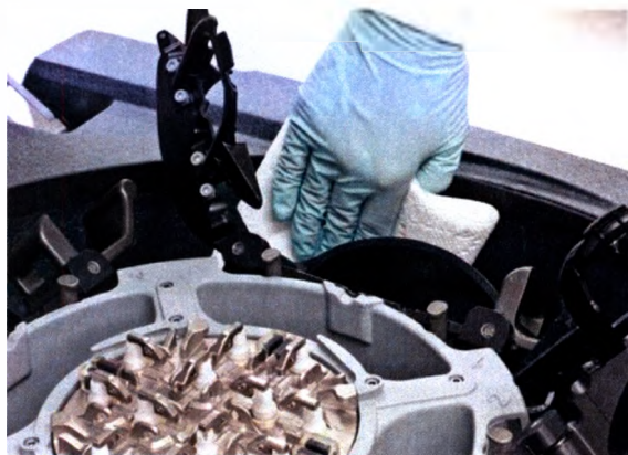
Рис. 5-7: Очистка стенок емкости центрифуги
