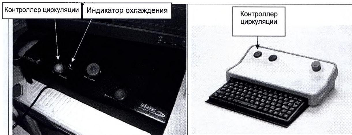
Рисунок 1-5. Контроллер циркуляции и индикатор охлаждения системы охлаждения ExAblate 2100 (слева) и 2100V1 (справа)
