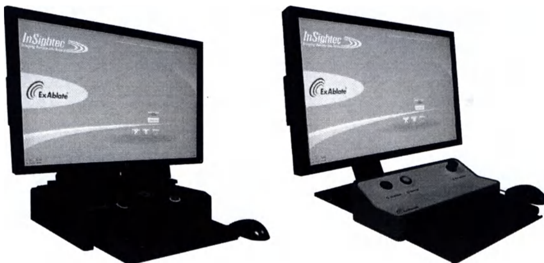
Рисунок 1-1. Консоль управления ExAblate модели 2100 (слева) и модели 2100V1 (справа)
