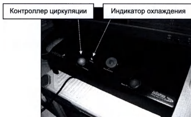
Рисунок 1-6. Контроллер циркуляции системы охлаждения и индикатор охлаждения ExAblate модели 2100
