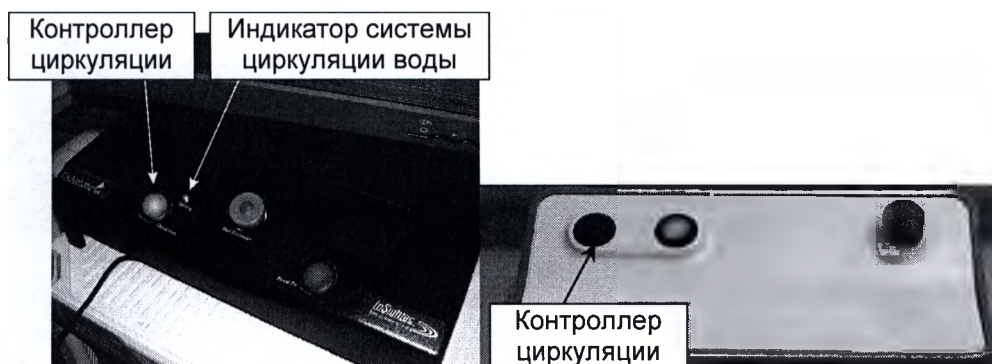
Рисунок 2-1. Слева — контроллер циркуляции и индикатор системы циркуляции воды ExAblate 2100, справа — контроллер циркуляции ExAblate 2100V1
