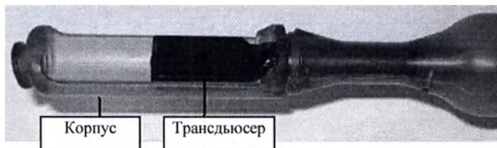
Рисунок 1-4. Датчик ExAblate 2100 Prostate, включающий трансдьюсер и корпус
