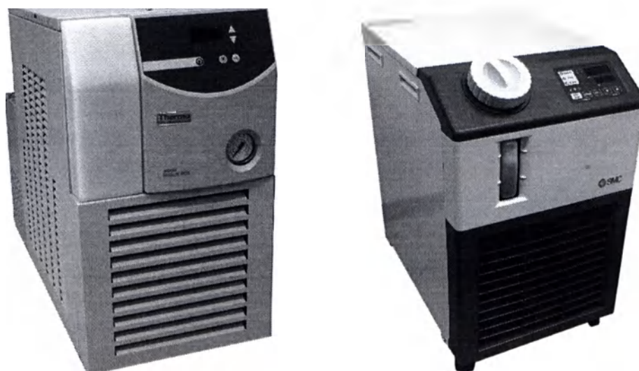
Рисунок 1–5. Система охлаждения ExAblate 2100 (слева) и 2100V1 (справа)
