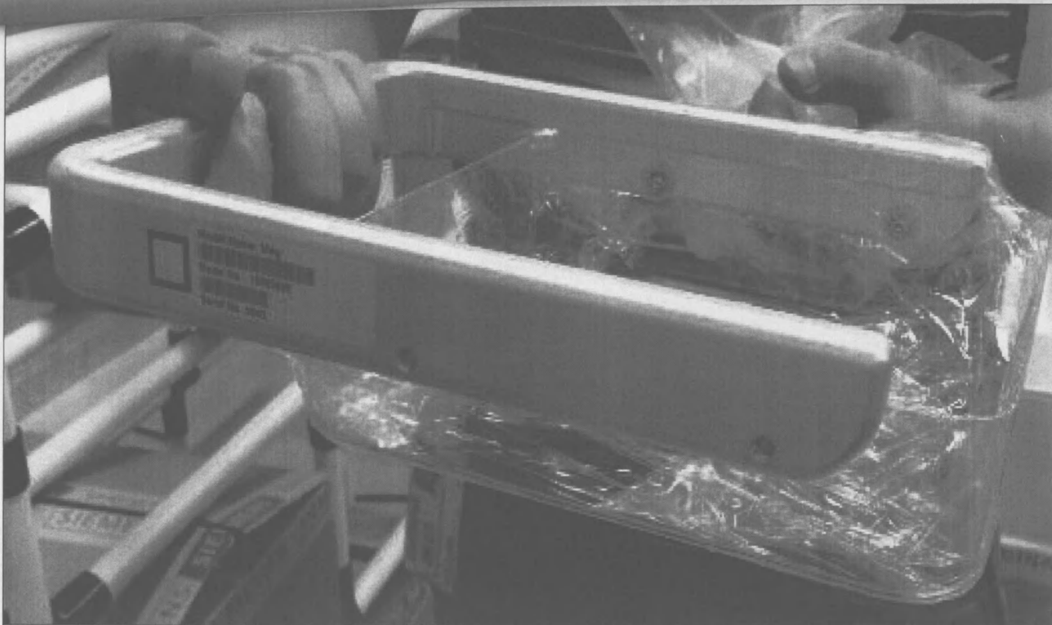
ПЛАСТИНА КОМПРЕССИОННАЯ ДЛЯ СЪЕМКИ С УВЕЛИЧЕНИЕМ 1,8/1,5
