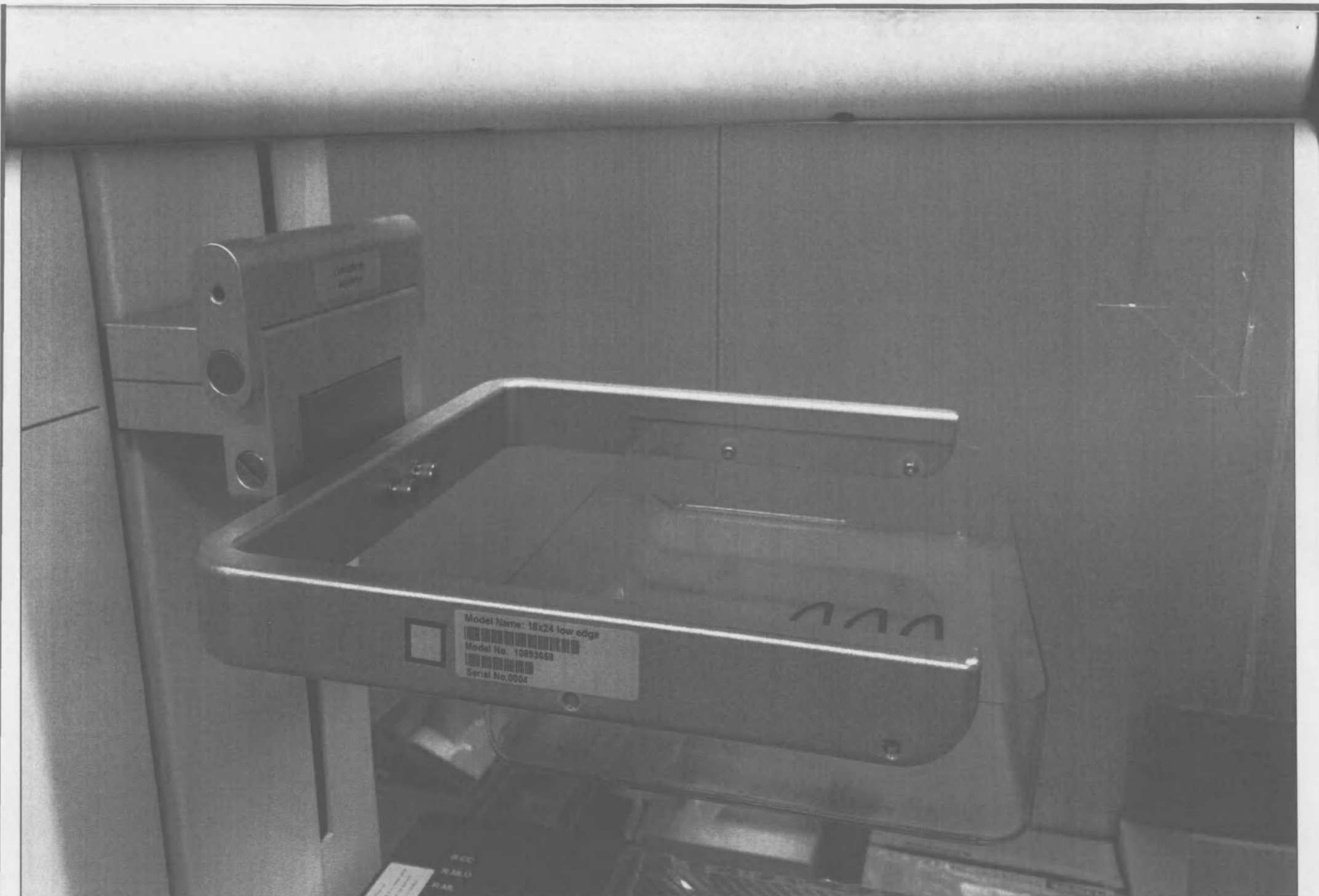
Пластина компрессионная 18 см x 24 см с низким краем или Пластина компрессионная 24 см x 30 см с низким краем
