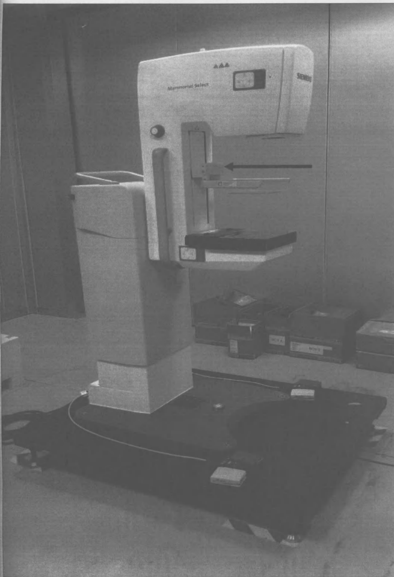
ШТАТИВ: - СТОЙКА СО ВСТРОЕННЫМ ГЕНЕРАТОРОМ; - ПОВОРОТНЫЙ ШТАТИВ; - КОМПРЕССИОННОЕ УСТРОЙСТВО; - ОБЪЕКТНЫЙ СТОЛ BUSKY 18 см x 24 см или стол BUSKY 24 x 30 см; - НОЖНЫЕ ПЕРЕКЛЮЧАТЕЛИ (ДВЕ ПАРЫ).
