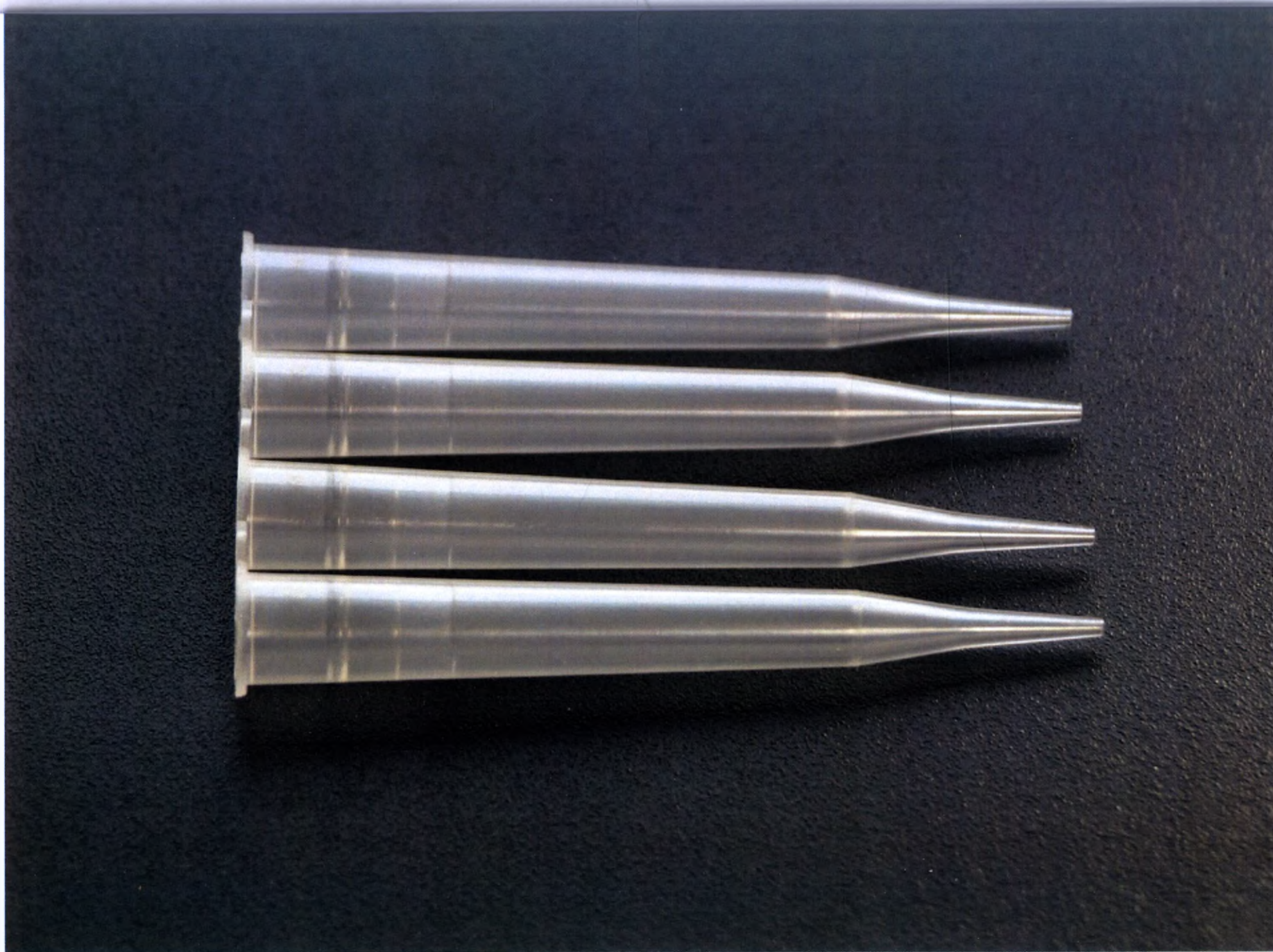
Рис 10. - Наконечник полимерный одноразовый к дозаторам пипеточным НП- «Термо Фишер Сайентифик» для четырехканального дозатора на (0,5–300) мкл
