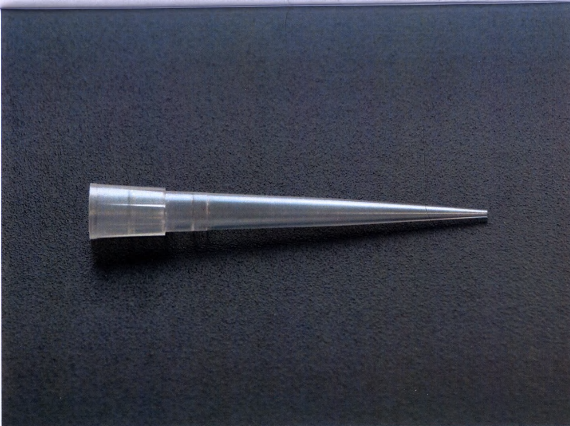
Рис 4. - Наконечник полимерный одноразовый к дозаторам пипеточным НП-«Термо Фишер Сайентифик» для одноканального дозатора на (0,5–250) мкл
