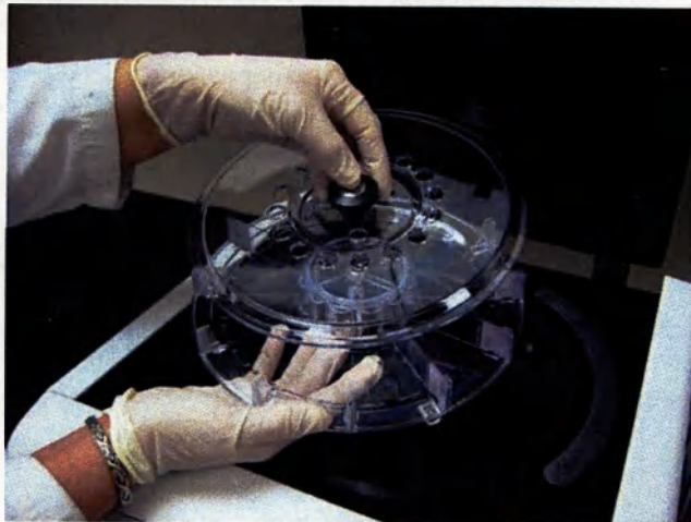
Рисунок 26. Снятие крышки карусели
