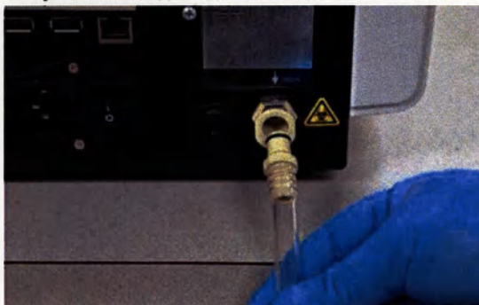
Рисунок 10. Подсоединение сливного шланга для отходов к прибору
