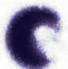
Рисунок 20. Неправильный результат теста рассеивания на ступице
