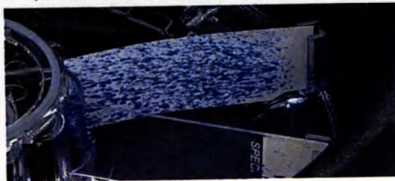
Рисунок 37. Правильный результат теста рассеивания на стеклах
