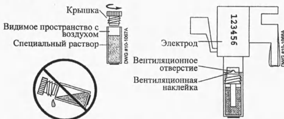
Рисунок 5. Мембрана PC02 (отвинтить крышку и установить на электрод)
