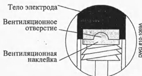
Рисунок 6. Вентиляционная наклейка на мембране.
