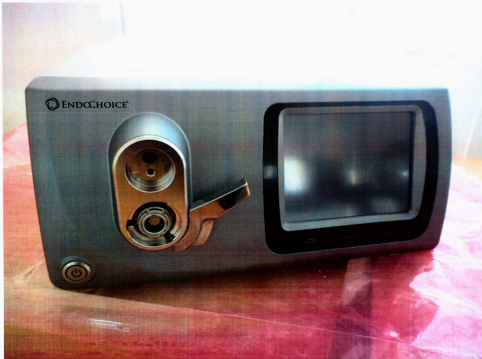
Процессор FuseBox со встроенным источником света
