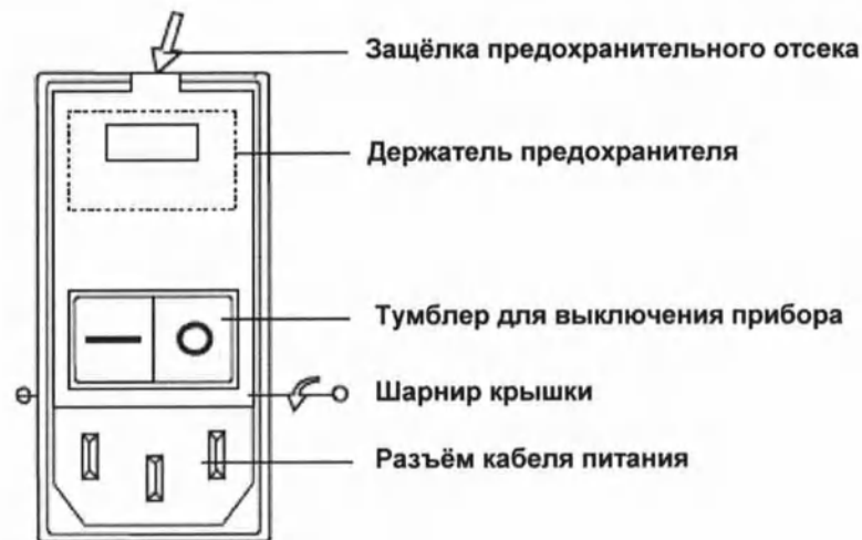
Рис. 186. Замена предохранителей и переключатель напряжения
