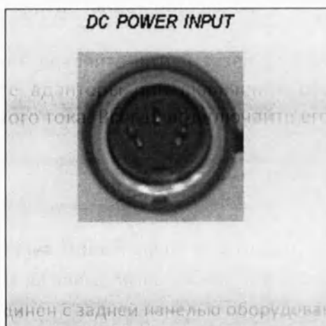
Рис. 3-2 Деталь задней панели – разъем подключения внешней батареи или источника постоянного тока
