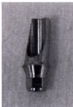
Абатмент постоянный угловой 15 град. с шестигранником, диаметр 4,80 мм (М), длина 9,18 мм, высота 6 мм
