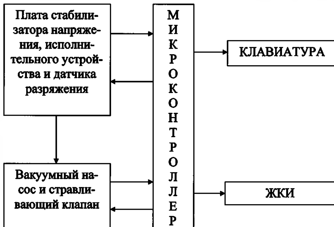
Рис. 2 Структурная схема массажера.
