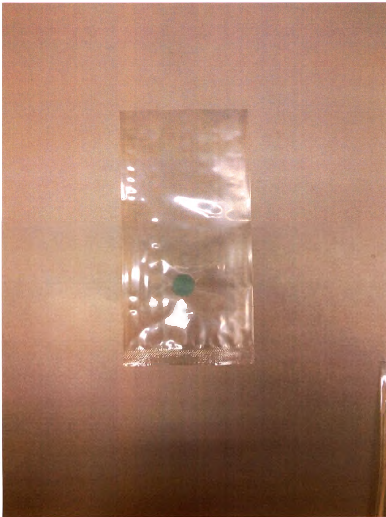
Фото 5. «Пакет полимерный термосвариваемый для воздушной и радиационной стерилизации «ППТи» с индикатором класса 1, 100x200мм «СтериТ®» ТУ 9398-106-11764404-2015».
