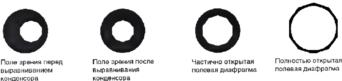
Рис. 10 Настройка освещения по Келеру.
