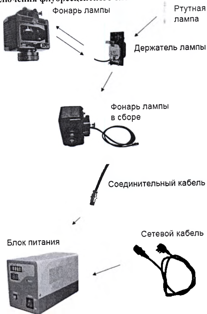
Рис.13. Схема подключения флуоресцентного блока
