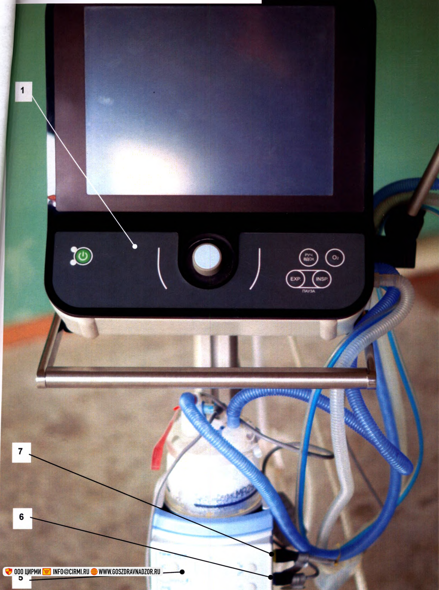
Рисунок 2 - Аппарат искусственной вентиляции лёгких неонатально-педиатрический «Прана» дА 2.931.018. Вид спереди, где: 1- блок вентиляции дА 2.931.019; 5 - увлажнитель дыхательных смесей MR850; 6 - температурный датчик для увлажнителя, вариант исполнения 900MR869; 7- кабель гибкого нагревателя, вариант исполнения 900MR805
