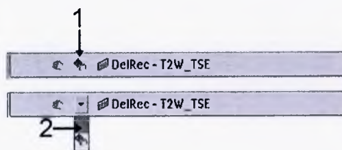
Рис. 314: Щёлкните по пиктограмме "Пауза, заданная пользователем", чтобы начать реконструкцию. 1: сперва щёлкните по пиктограмме, 2: затем щёлкните по пустому месту под стрелкой.
