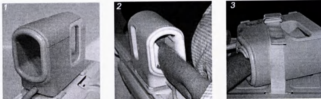
Рис. 117: 1 — Катушка (на основании). 2 — Исследование левого запястья — сбоку — ногами вперед. 3 — Исследование правого запястья при его положении над головой.
