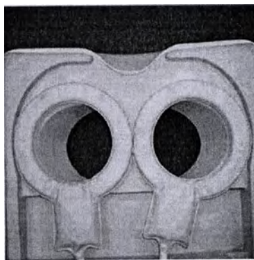
Рис. 148: Катушки SENSE Flex-L на специальном матрасе для груди.
