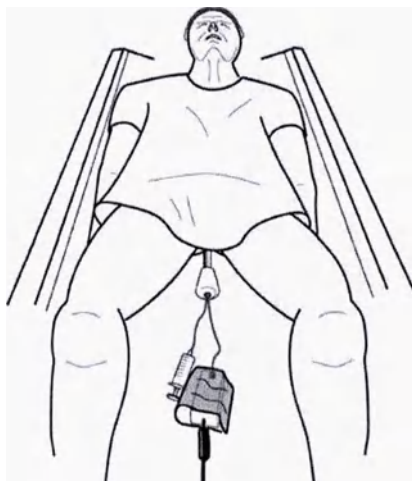
Рис. 104: Укладка кабеля катушки Endo и блока предусилителя.
