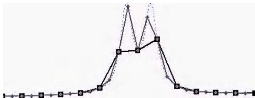
Рис. 289: Заполнение нулями приводит к интерполяции в частотной области. Черная линия — это спектр с двумя пиками с низким разрешением. Заполнение нулями данных для удвоения числа точек выявило два явных пика (серая линия). Серая пунктирная линия демонстрирует эффект сглаживания от дальнейшего заполнения нулями. Разрешение может быть значительно повышено, а спектр с заполнением нулями будет выглядеть лучше.
