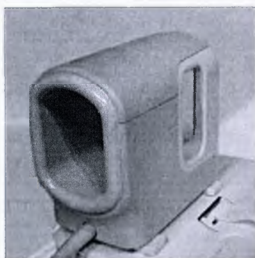
Рис. 115: Катушка Hand/Wrist 4 на деке стола.
