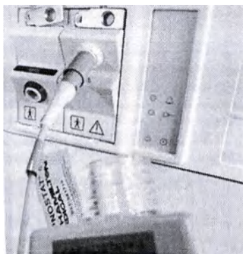
Рисунок 4-4. Настройка калибровки адаптера/датчика CO 2
