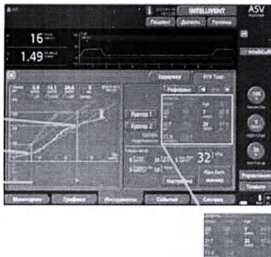
Рисунок 9-6. Использование функции курсора в окне «P/V Tool Pro»: построение кривой линейной податливости
