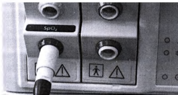
Рисунок F-22. Подключение кабеля датчика SpO 2 к аппарату ИВЛ (Masimo)
