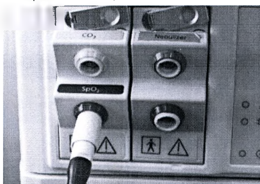
Рисунок F-26. Подключение кабеля пациента аппарату ИВЛ (Masimo)
