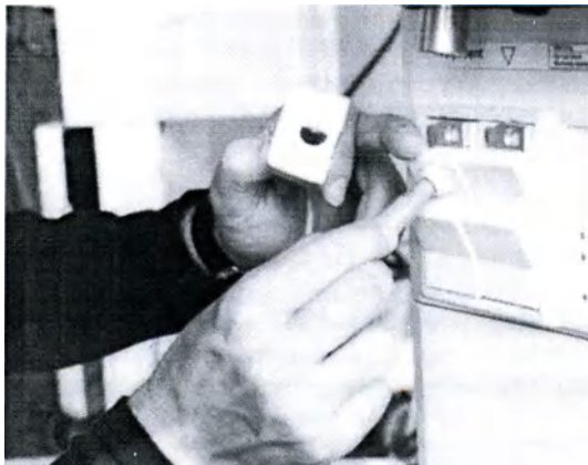
Рисунок 3-2. Подключение кабеля датчика CO 2
