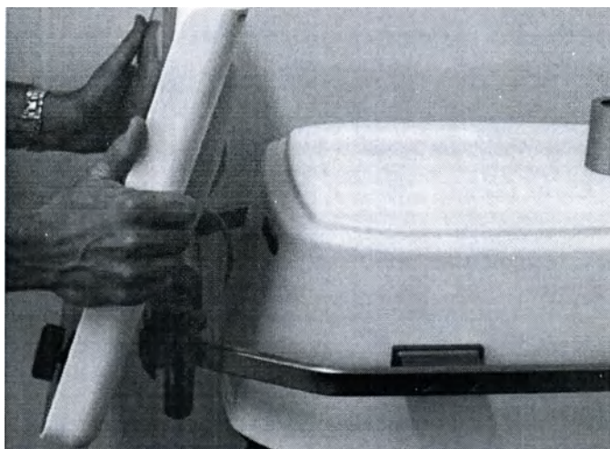
Рисунок 2-3. Установка панели системы мониторинга Ventilation Cockpit
