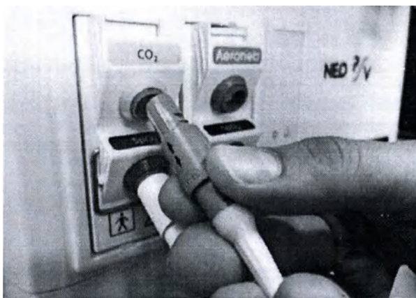
Рисунок 3-6. Подключение кабеля датчика CO 2
