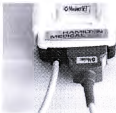
Рисунок F-23. Подключение кабеля пациента к адаптеру SpO 2 (Masimo)
