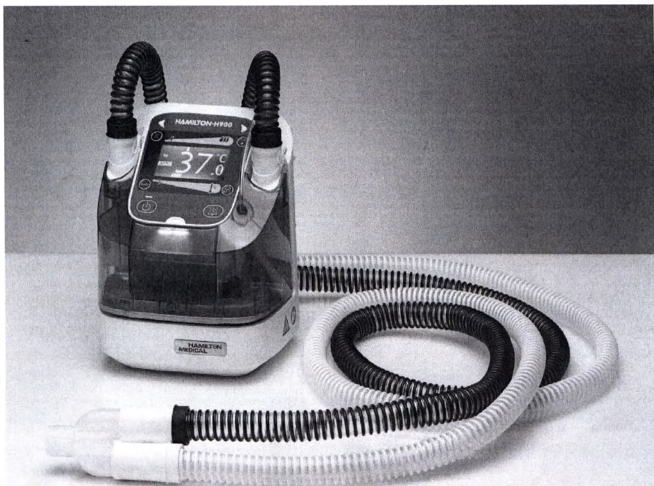
Фото 43 - Увлажнитель автоматический для использования с двойным температурным датчиком.
