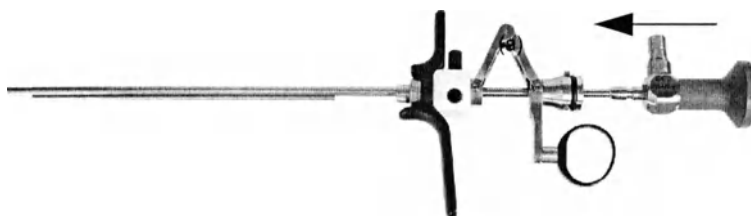
Рисунок 9: Подключение цистоскопа на 4 мм в механизм блокировки
