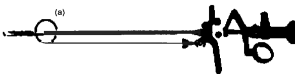
Рисунок 10: Установка электрода в направляющую трубку электрода
