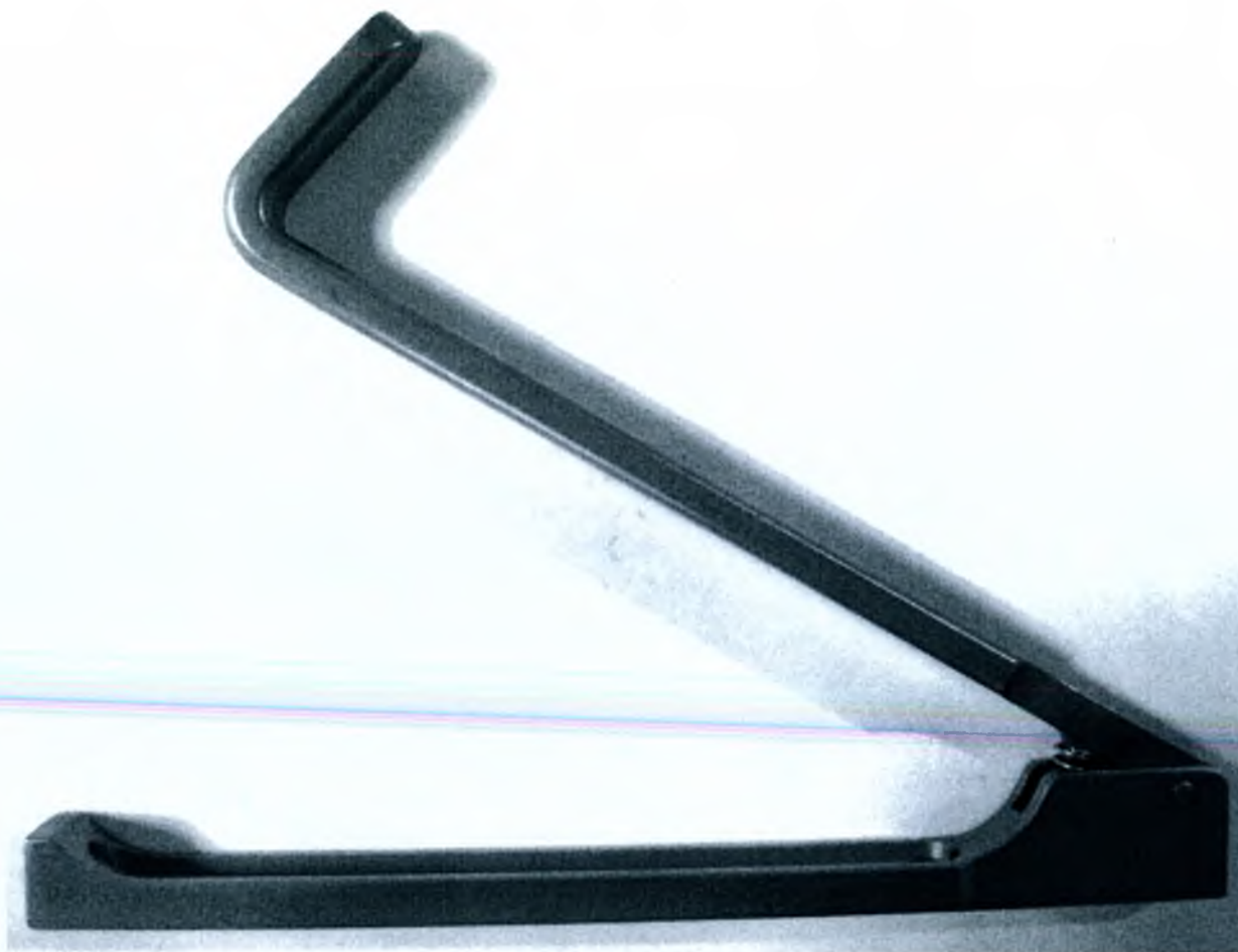
Вытягиватель пина, вытягиватель пина для крестообразной связки
