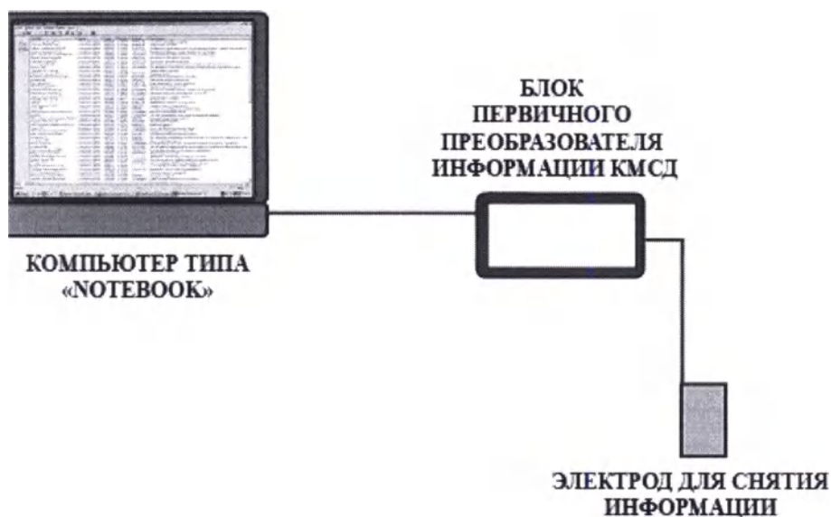
Рисунок 1. Схема соединения составных частей КМСД
